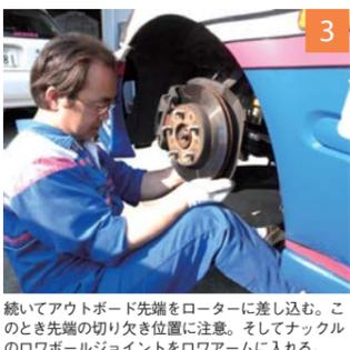
続いてアウトボード先端をローターに差し込む。このとき先端の切り欠き位置に注意。そしてナックルのロワボールジョイントをロワアームに入れる。
