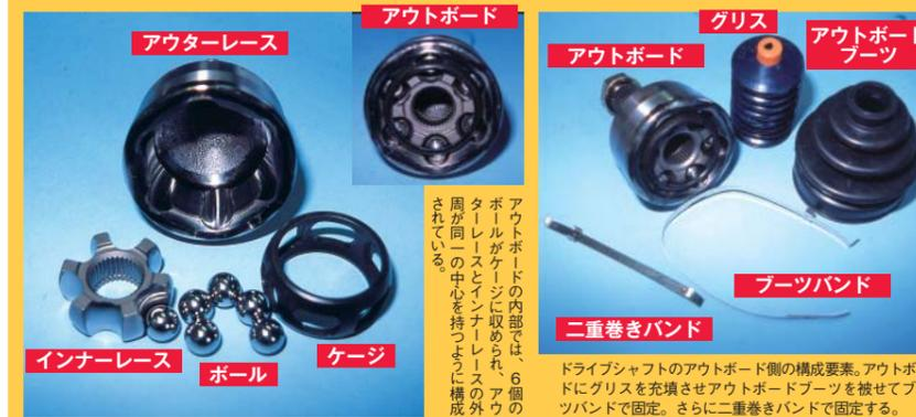
アウトボードの内側には、6個のボールがケージに収められ、アウトレースとインナーレースの外周が同一の中心を持って構成されている。
