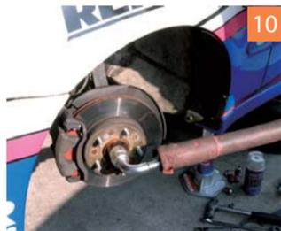
32ミリのソケット+トラック用レンチに鉄パイプをかませてハブセンターナットを固定。結構な力が掛かるので、周囲の安全には注意を。
