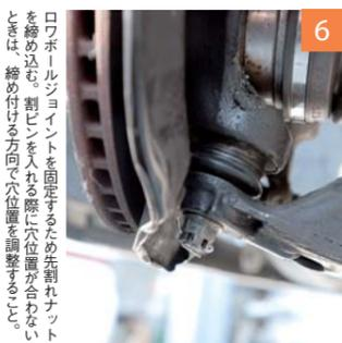
ロワボールジョイントを固定するため先割れナットを締め込む。割ヒンを入れる際に穴位置が合わないときは、締め付ける方向で穴位置を調整すること。
