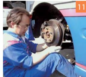
11 ボールジョイントをロワアームから抜き、ローターを車体外側に引っ張りながらドライブシャフトのアウトボード先端をローターから抜く。
