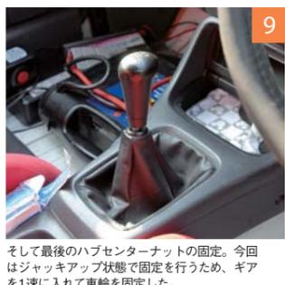
そして最後のハブセンターナットの固定。今回はジャッキアップ状態で固定を行うため、ギアを1速に入れて車輪を固定した。
