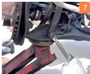
足回りの本締めは、ジャッキなどで仮懸着地状態にし、1Gの圧力をかけて行うこと。ゴムブッシュがねじれて固定される可能性があるからだ。
