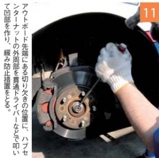
アウトボード先端にある切り欠きの位置に、ハブセンターナットの外周部を通過させ、パイプなどで叩いて凹部を作り、緩み防止措置を施す。
