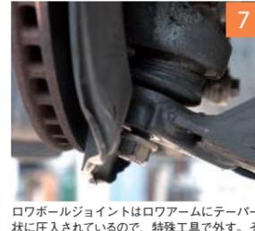
7 ローボールジョイントはロワアームにテーパ状に圧入されているので、特殊工具で外す。その準備として、ローボールジョイント下部のボルトに前行程で外したナットを装着。ボルトの頭を出さないようにしておくのがポイント。
