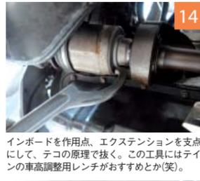
14 インボードを作用点、エクステンションを支点にして、テコの原理で抜く。この工具にはティンの高調整用レンチがおすすめとか(笑)。
