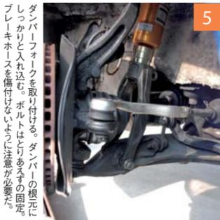
ダンパーフォークを取り除ける。ダンパーの根元にしっかりと入れ込む。ホルトはとりあえずの固定。ブレーキホースを傷付けないように注意が必要だ。
