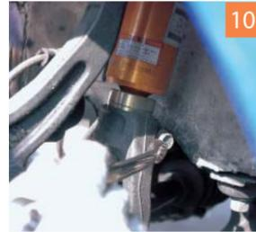
10 ボールジョイント外しが終わったので、ここからはサクサクと。ダンパーフォーク上部のボルト(14ミリ)を外してダンパーフォークを抜く。
