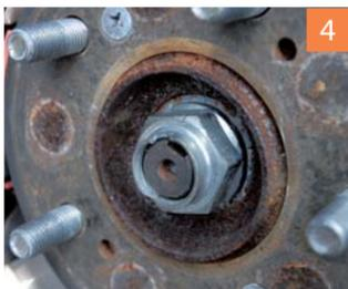
先端部の切り欠き位置は上向きにしておくのがポイント。ハブセンターナットを被せる。本締めは最後に行うので、とりあえずの固定。
